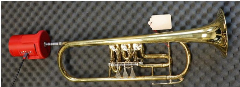
Abbildung 10: Messung der Eingangsimpedanz der Mustertrompeten
