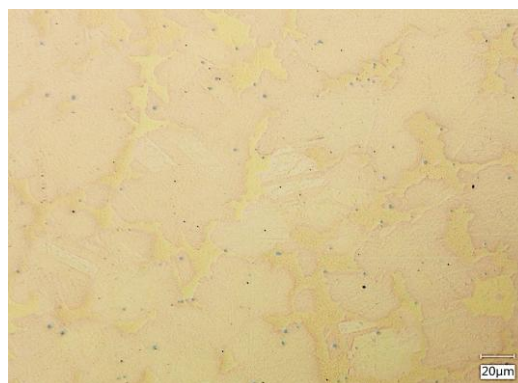
Abbildung 4: Lichtmikroskopische Gefügaufnahme der Legierung CuZn39Fe0,8 im weichgeglühten Zustand
