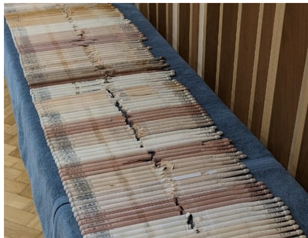
Abbildung 9: Muster-Drumsticks aus alternativen Holzwerkstoffen nach den Prüfungen
