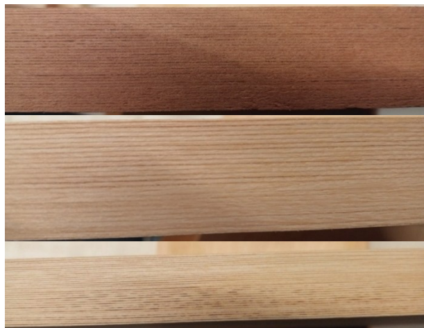
Abbildung 7: Besäumte Balken mit Montage-PUR-Klebstoff aus Elsbeere (oben), Birke (mitte) und Ahorn (unten)
