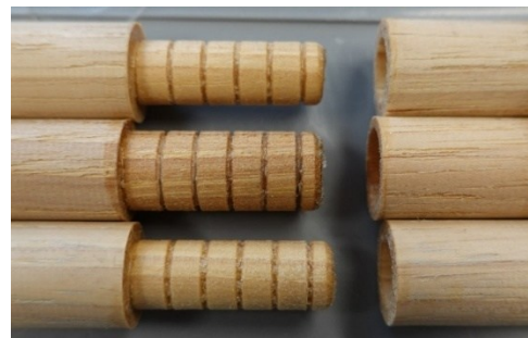
Abbildung 11: Gelöste Zapfenverbindungen infolge einer unzureichenden Klebstoffverteilung
