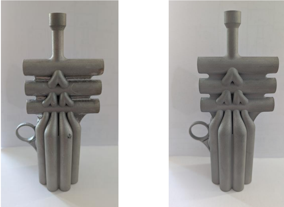
Abbildung 9: Bauteil vor dem Strahlen (links) und nach dem Strahlen mit Strahlmittel FINAL nach 15 Min Strahldauer (rechts)
