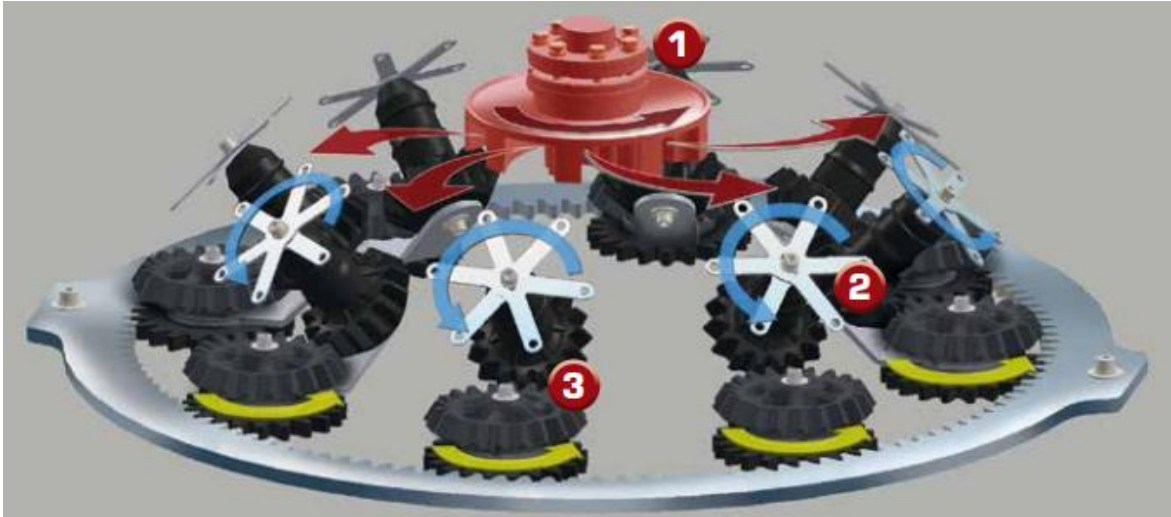
Abbildung 8: Funktionsprinzip Strahlverfahren „Twister“, 1: Schleuderrad, 2: Werkstücke, 3: Werk-stückträger (Quelle: BMF GmbH)
