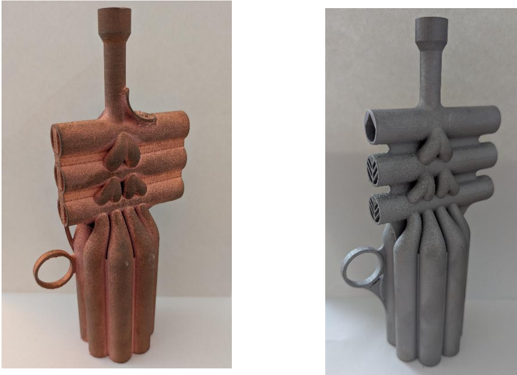
Abbildung 5: Bauteil in Kupfer (links) und Bauteil in 316L (rechts)
