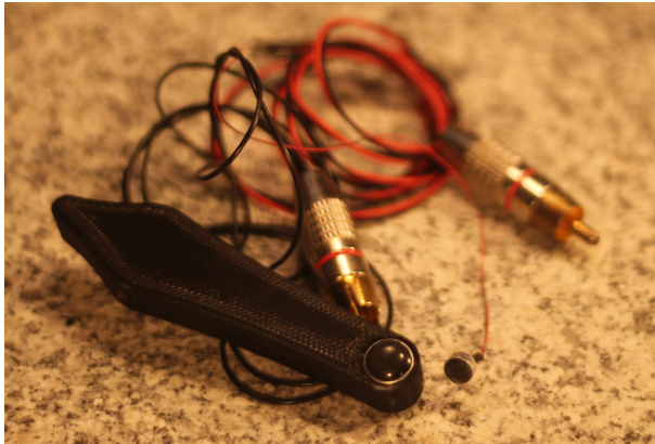
Abb. 5: Von Hand gehaltener Impulshammer und mit Epoxidharz verschlossenes Elektretmikrofon als einfacher Beschleunigungsaufnehmer.
