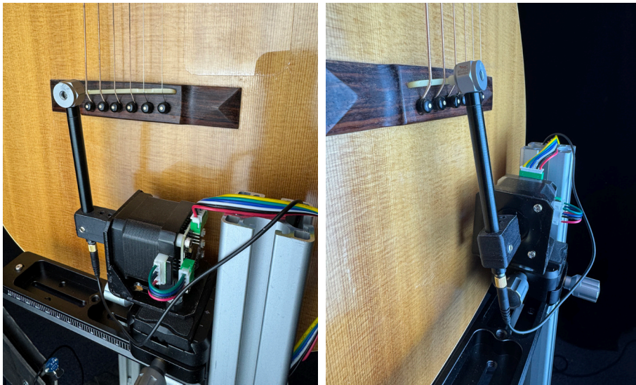
Abb. 10a und 10b: Automatisierter Impulshammer auf einer Schiene vor dem Instrument.
