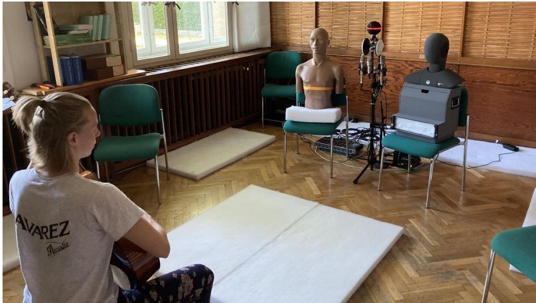
Bild 3 Aufbau für die Aufnahmen in Studioumgebung in einem Studioraum der Professur für Akustik und Haptik. Die Aufnahmen ausgewählter Standardmikrofone, binauraler Mikrofone bzw. Schallfeldmikrofone wurden im Rahmen der virtuellen Beurteilungen verwendet (vgl. Bild 9).
