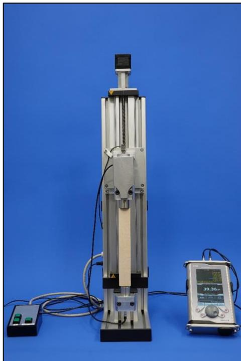
**Abbildung 2: Ultraschallprüfung an Holzproben**
