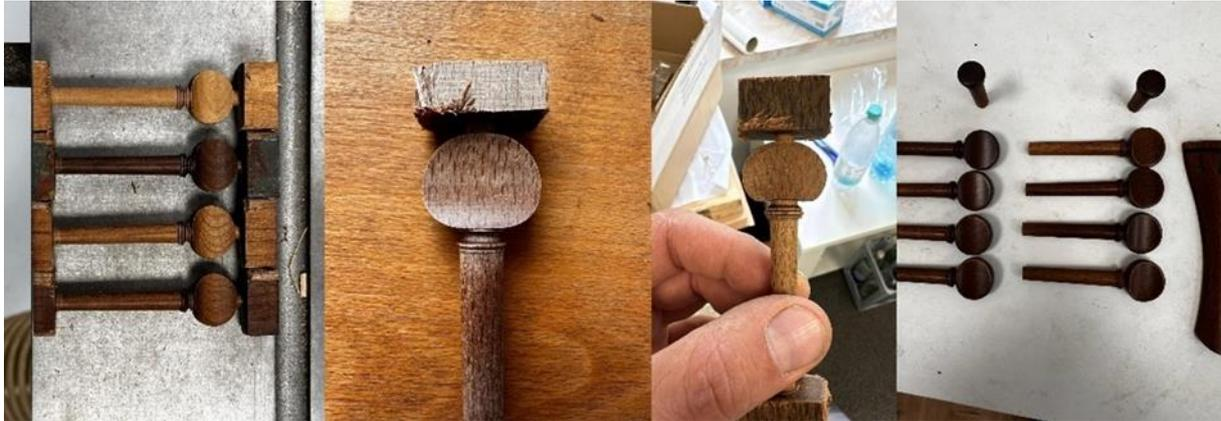
Abbildung 12: Wirbelfertigung aus verdichtetem Rotbuchenmaterial
