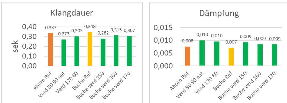
Abbildung 10: Klangdauer und Dämpfung der verdichteten Proben im Vgl.
