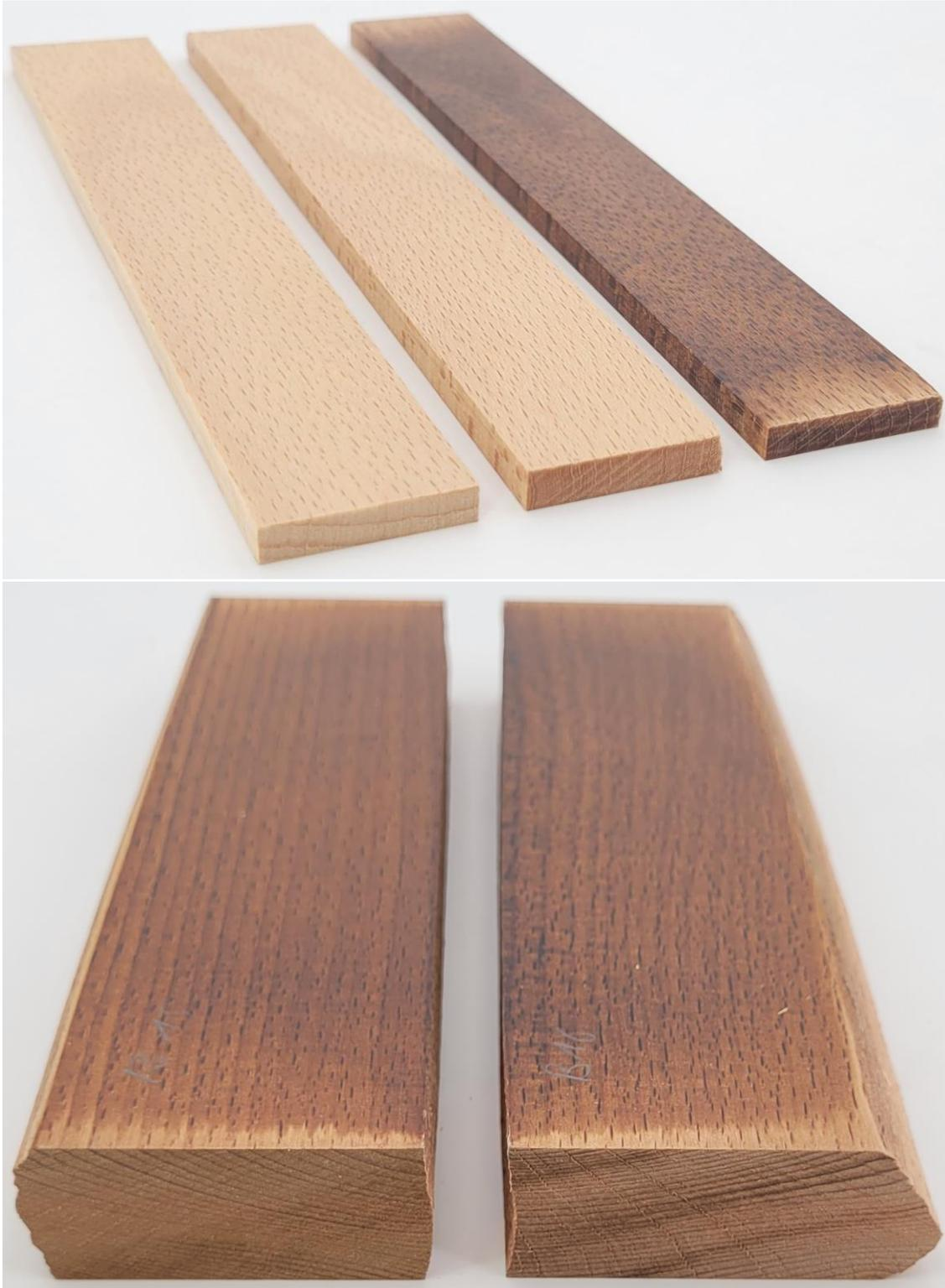
**Abbildung 11: Verdichtete Laborproben sowie Rohlinge zur Wirbelfertigung**
