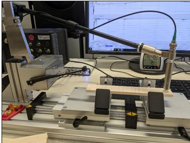
**Abbildung 1: Modalanalyse zur Ermittlung der Dämpfung und der Klangdauer**
