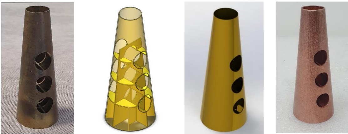
Abbildung 5: Konstruktive Umsetzung; v. l. n. r.: Traditionsbauteil, Bauteildesign mittels CAD, Bauteilübernahme in Postprozessor (CAM), mittels AM gefertigtes Bauteil
