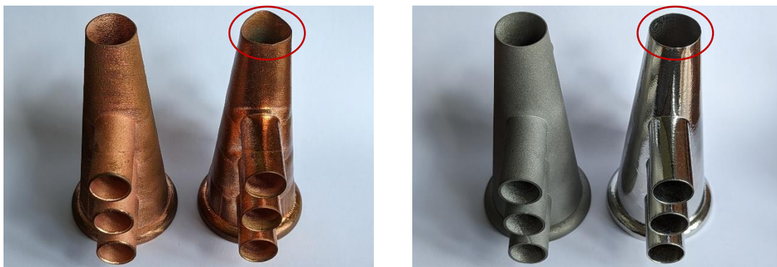
Abbildung 20: Luftstromverteiler aus Kupfer (links) und Edelstahl (rechts)
