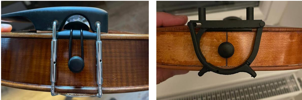
Abbildung 11: links: montierte Kinnhaltermechanik; rechts: Schiebemechanismus
