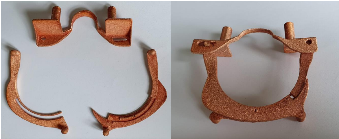
Abbildung 17: In Kupfer mittels SLM getrennt hergestellter Schiebemechanismus
