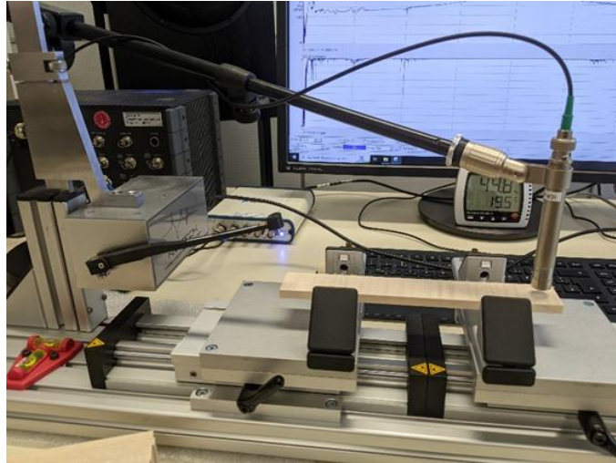
Bild 2: Modalanalyse zur Ermittlung der Dämpfung und Klangdauer
