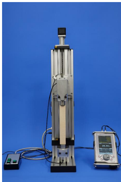
Bild 3: Ultraschallprüfung an Holzproben
